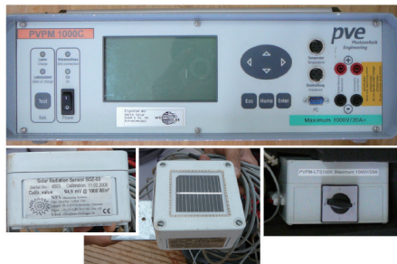
（IV仪与固定式照度计相连接，综合实时电压，电流，照度与温度等数据计算出最高功率值）
